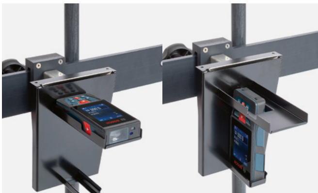
Digitální nastavení výšky od podlahy pomocí laseru. Laserové digitální měření vzdálenosti k radarovému senzoru
