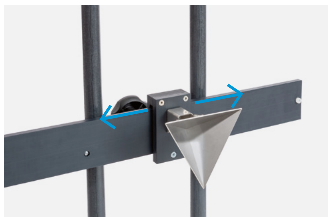
Trojité zrcadlo se stupnicí pro přesné ustavení offsetu
