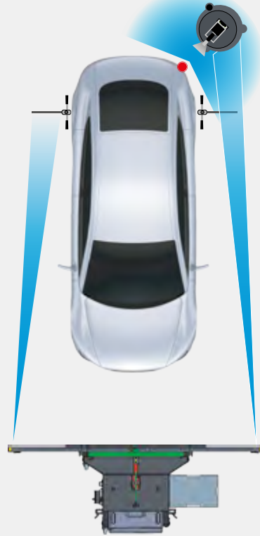
Ustavení CTA 120 pro zadní radarové snímače pomocí DAS 3000
