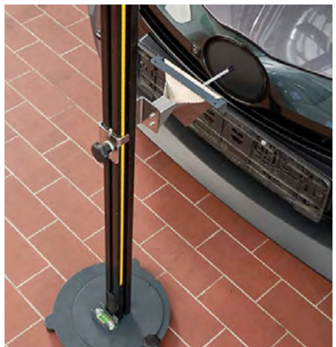
Možnost nastavení výšky pomocí mechanického ukazatele směřujícího na referenční bod vozidla (znak)
