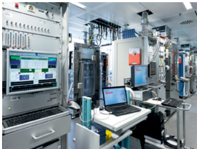
Vytrvalostní testovací stolice v high-tech laboratoři: ENV6 podporuje vysoký dynamický výkon a životnost moderních brzdových systémů.
