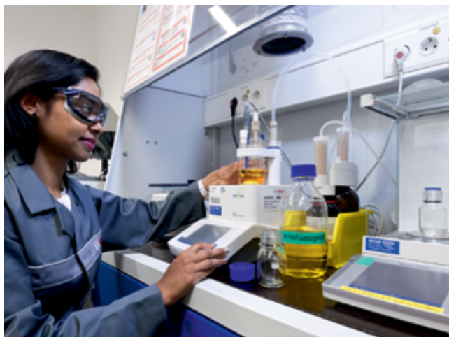
Bosch ENV6 v laboratorním testu: Brzdová kapalina je podrobena chemickým testům ve vývojovém středisku Bosch.
