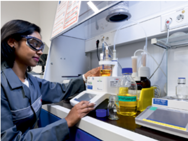
Bosch ENV6 v laboratórnom teste: Brzdová kvapalina je podrobená chemickým testom vo vývojovom stredisku Bosch.
