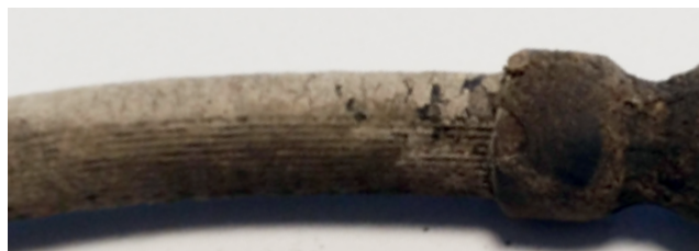
Brzdová hadička s vypadanou gumou
