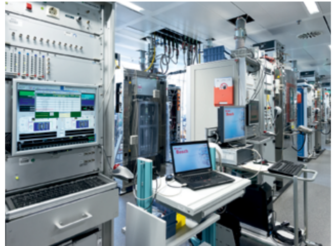
Vytrvalostné testovacie stoly v high-tech laboratóriu: ENV6 svojou vysokou dynamikou podporuje výkon a životnosť moderných brzdových systémov.
