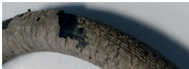
Brzdová hadička s vypadanou gumou
