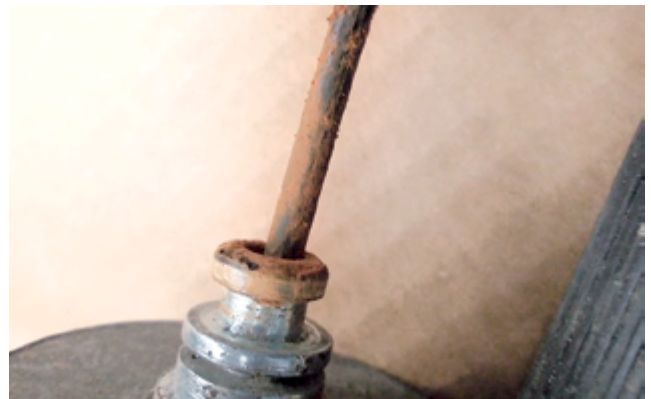
Zhrdzavené a tuhé brzdové lanko
