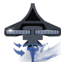
Profil pryžové stírací lišty s dlouhou životností pro snížení znečištění, oděru a opotřebování
