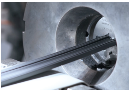
Během extrudování se míchají různé pryžové materiály tak, aby se vytvořil okraj a zadní část stírací lišty
