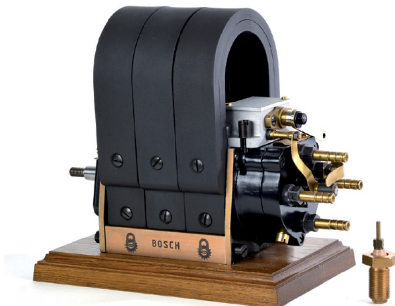
Vysokonapäťové napájanie typu Magneto so zapalovacou sviečkou bolo univerzálne použiteľné a prinieslo spoločnosti Bosch obrovský úspech.
