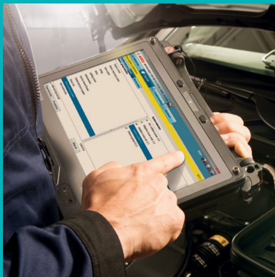
DCU 220 Tablet-PC so servisným software ESI[tronic] 2.0
