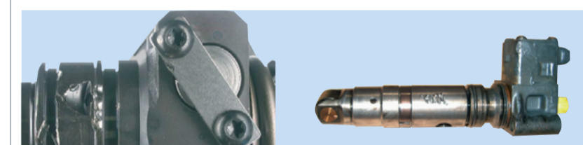
Silné mechanické poškození, poškození pouzdra nebo těsnicí plochy
