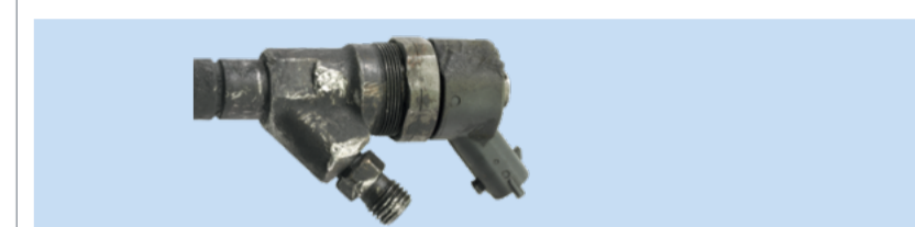
Rozsáhlé mechanické poškození
