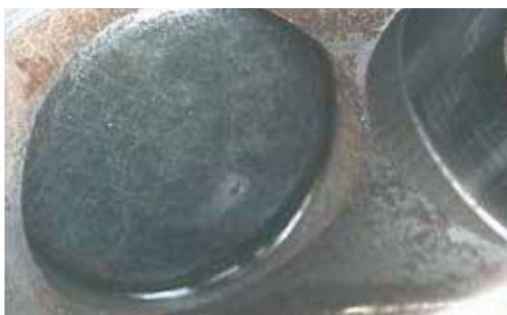
Корозія корпусу насоса високого тиску
